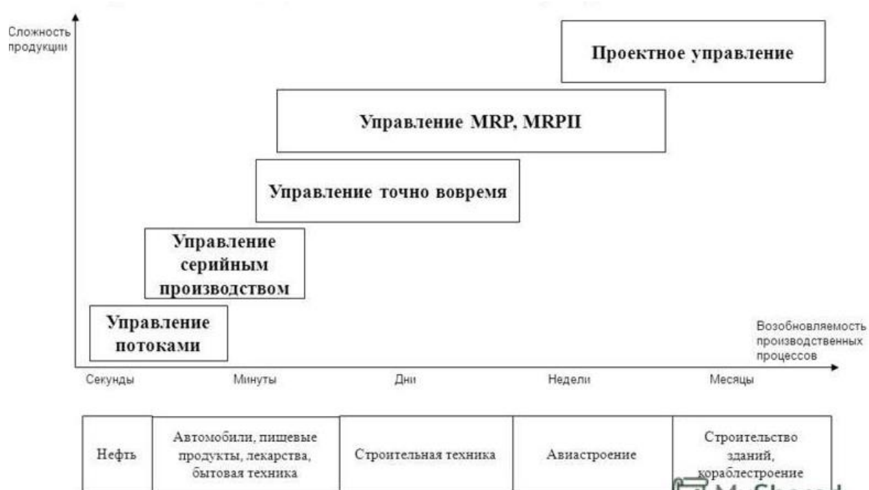
Рисунок 6 – Классификация систем производственного управления 6
